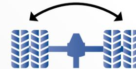
Tauschen Sie beide Komplettäder eines Zwillingspaars von der linken zur rechten Fahrzeugseite und umgekehrt.
