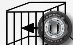
✓ Pumpen Sie jeden Nutzfahrzeugreifen in einem Pumpkäfig bis zu seinem Betriebsdruck auf.
