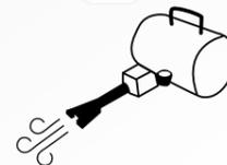
Ein zu enger Wulstabstand kann das Befüllen des Reifens mit Luftdruck erschweren, in diesem Fall nutzen Sie bitte einen „Luftdruckbooster / Füllbombe“.
