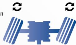
Demontieren Sie beide Reifen der Lenkachse von den Felgen und montieren Sie diese erneut mit der ihrer Außenseite nach innen.
