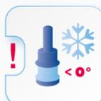
Vorsicht bei Luftdruck-Kontrollen während Temperaturen unter dem Gefrierpunkt! Dabei kann der Ventileinsatz durch entstehende Eiskristalle dauerhaft blockieren, was zum Absinken des Reifeninnendrucks führt.
