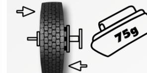
✓ Falken empfiehlt, jeden Reifen unabhängig von der Achsposition mit einer Auswuchtmaschine dynamisch auszuwuchten.
